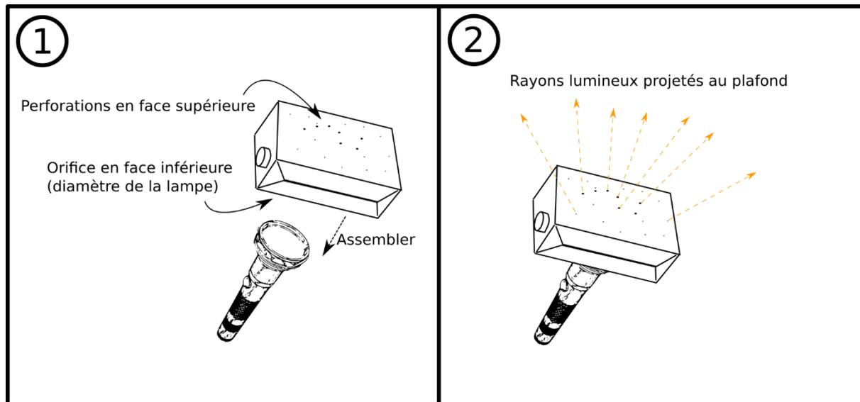
*Illustration 1: Principe de fabrication d'un projecteur d'étoiles, à partir d'une lampe torche et d'une brique de lait vide (© S. Rondi).*
